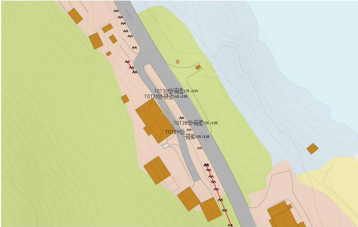
Figur 29. Skisse som viser detalj fra borplan. Røde linjer viser områder hvor det er påvist berg i dagen.
