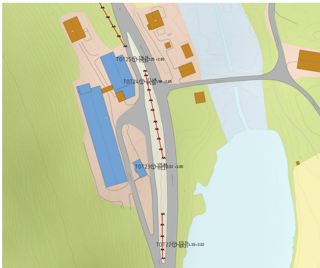
Figur 21. Skisse som viser detalj fra borplan. Røde linjer viser 3 områder hvor det er påvist berg i dagen.
